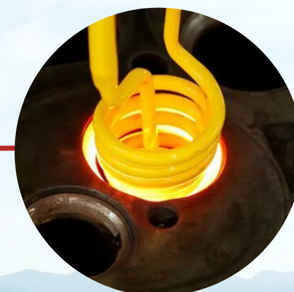
Extração de sedes de válvulas
